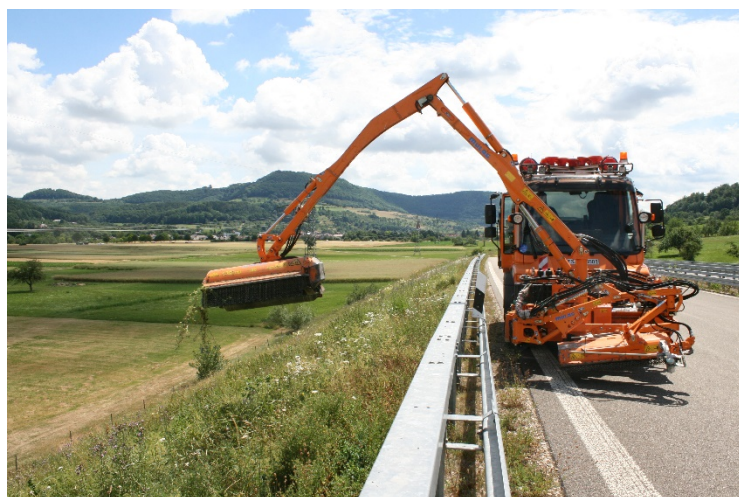
Foto 9 Schwerlastgeräteträger der Straßenmeisterei Geislingen an der Steige mit Auslegermähgerät und Schlegelmulcher. Foto: ILU
