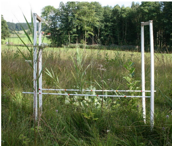
Foto 1 Vorrichtung zur Messung der Vegetationsdichte. Foto: ILU.
